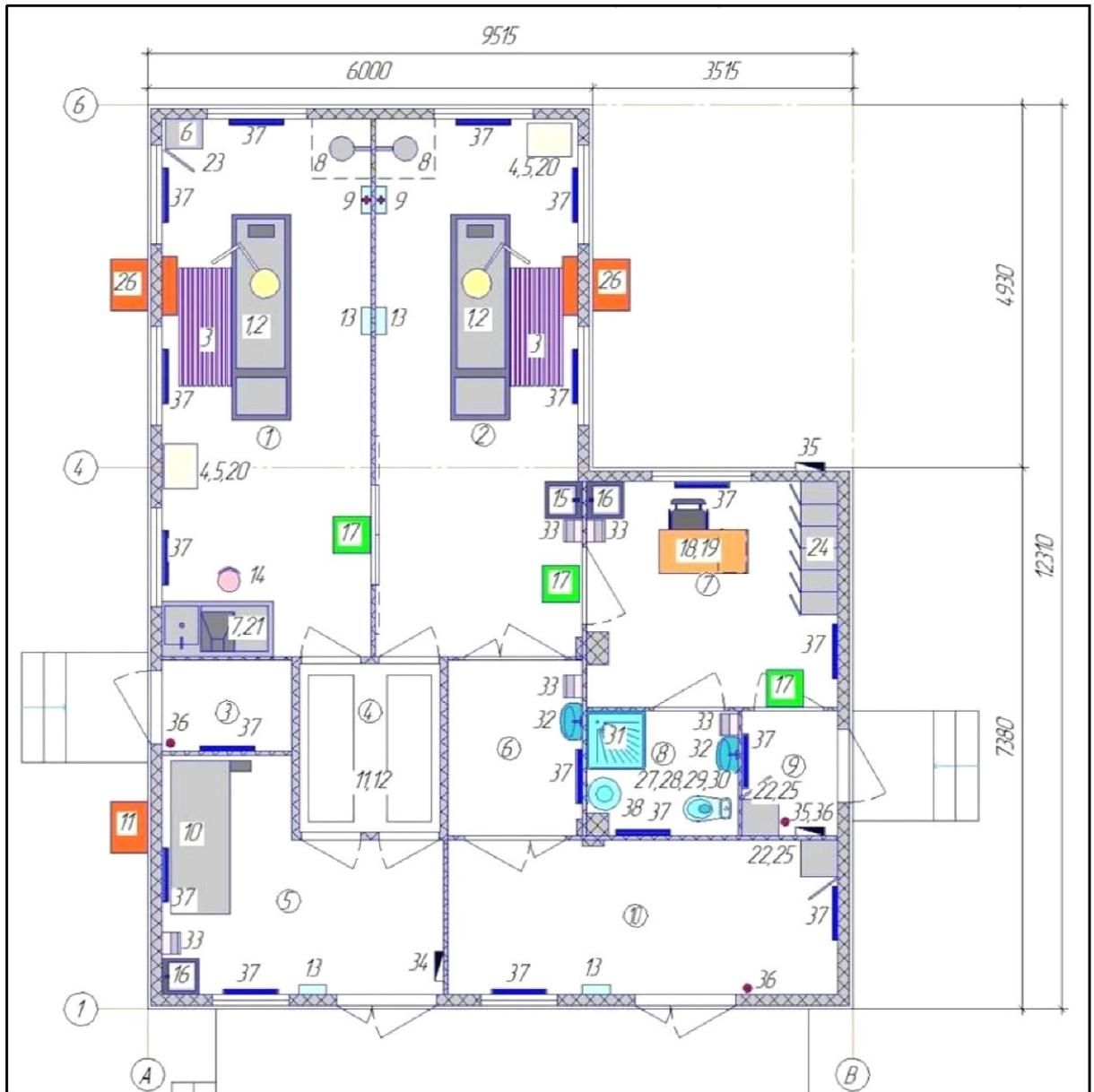
**Рис. 2.** Рекомендованный типовой план модульного здания, предназначенного для исследования инфицированных умерших (или с подозрением на их инфицирование).
